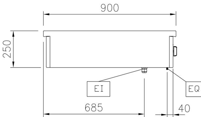
EI = Conexión eléctrica (energía)
